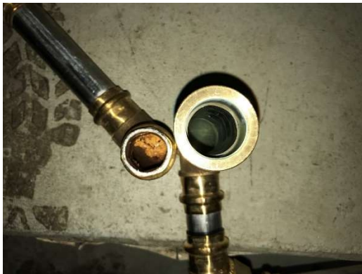
Sichtprüfung Vergleich nach drei Jahren: Links ohne, rechts mit BIOCAT
